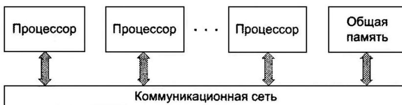
Рис. 1.6. Структура вычислительной системы с общей памятью
