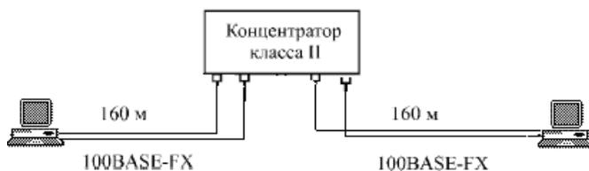
Рисунок 7. Сеть Fast Ethernet максимальной длины
