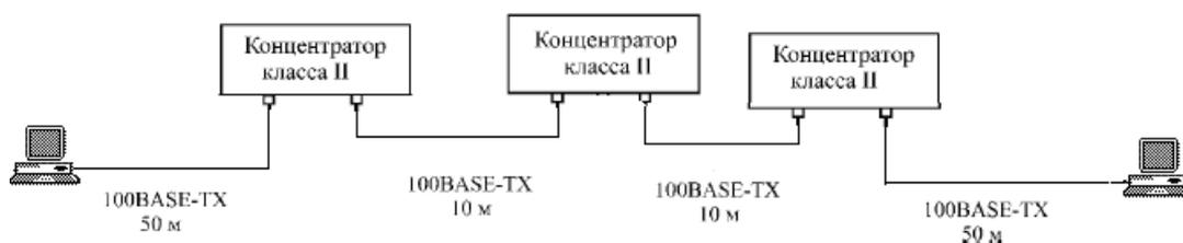
Рисунок 6. Пример работоспособной конфигурации сети, нарушающей правила модели 1
