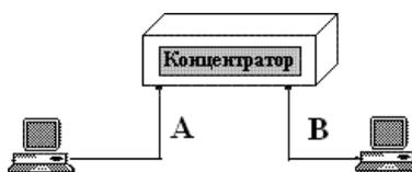
2. Соединение двух абонентов сети с помощью одного концентратора (репитера) класса I или класса II (рисунок 3).
