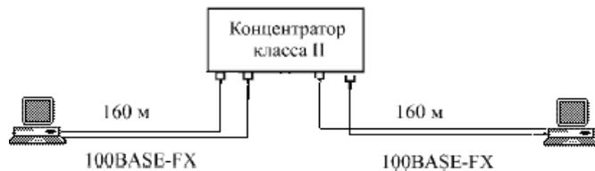
Рисунок 7. Сеть Fast Ethernet максимальной длины
