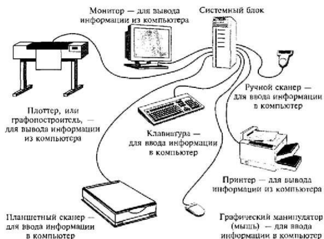
Рис. 2.3. Связи между компьютером и периферийными устройствами
