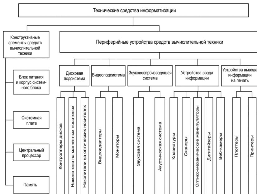
Рис. 1.4. Технические средства информатизации адрес, в конце цикла — данные). Для фиксации этих моментов (стробирования) служат специальные сигналы на шине управления. Понятно, что мультиплексированная шина адреса/данных обеспечивает меньшую скорость обмена, требует более длительного цикла обмена. По типу шины адреса и шины данных все магистрали также делятся на мультиплексированные и ^мультиплексированные.
