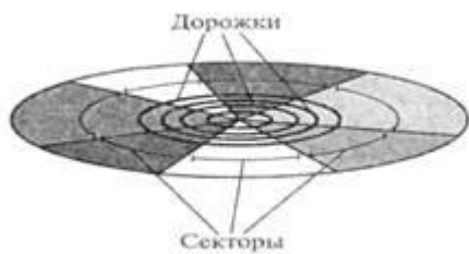
Рис. 1. Разбиение магнитного диска на дорожки и секторы при форматировании
