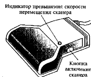
Рис. 6.9. Устройство ручного сканера
