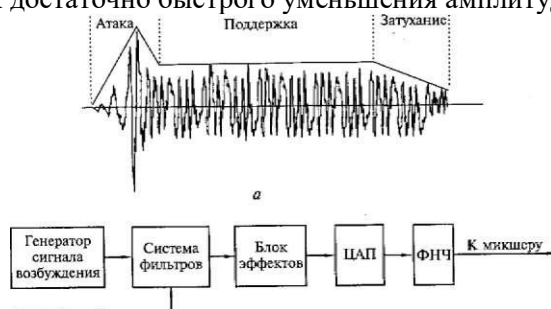
Рис. 5.5 Принцип действия современного синтезатора: а — фазы звукового сигнала; б — схема синтезатора
