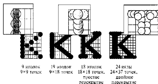
Рис. 7.2. Пример формирования буквы «К» матричными принтерами с различным содержанием и расположением иглолок в печатающей головке
